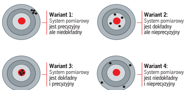
Rys. 2.6. Graficzna interpretacja precyzji i dokładności badania
