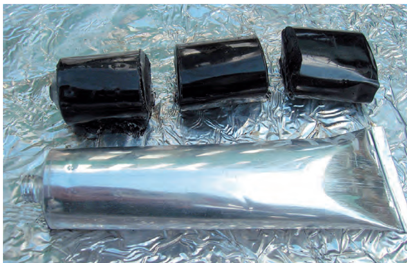
Rys. 3.31. Widok ogólny wypełnionej i zamkniętej tuby do wykonywania „testu tubowego” oraz pociętej na 3 części próbki asfaltu modyfikowanego (fot. ORLEN Asphalt sp. z o.o. dzięki uprzejmości ORLEN Laboratorium sp. z o.o.)
