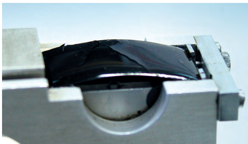
Rys. 3.9. Widok próbki asfaltu na płytce założonej na aparat półautomatyczny po wykonaniu badania – widoczne pęknięcie warstwy asfaltu (fot. ORLEN Asfalt sp. z o.o. dzięki uprzejmości ORLEN Laboratorium sp. z o.o.)
