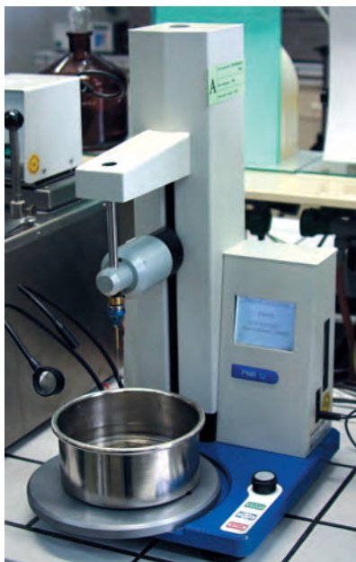
Rys. 3.2. Widok ogólny aparatu do badania penetracji z umieszczoną próbką asfaltu (fot. ORLEN Asphalt sp. z o.o. dzięki uprzejmości ORLEN Laboratorium sp. z o.o.)
