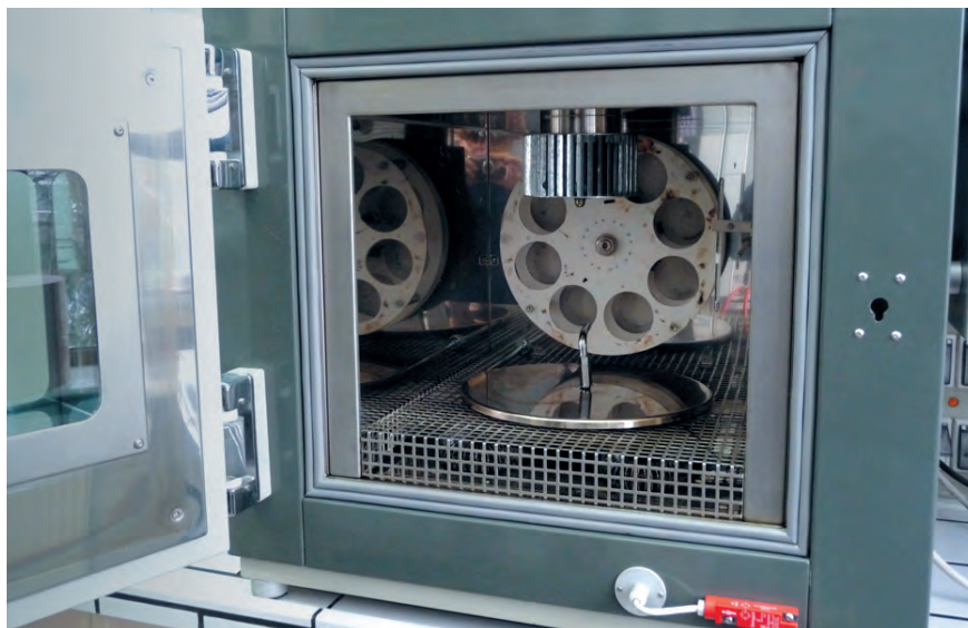
Rys. 3.24. Widok ogólny aparatury do przeprowadzania testu starzenia technologicznego RTFOT (fot. ORLEN Asphalt sp. z o.o. dzięki uprzejmości ORLEN Laboratorium sp. z o.o.)
