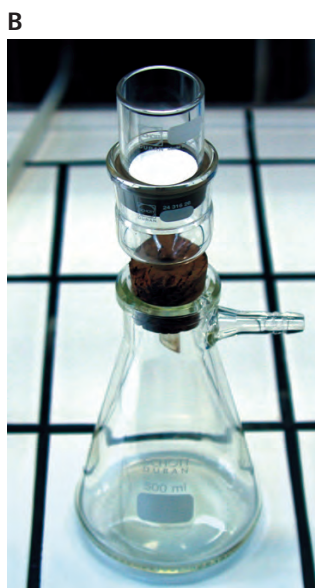
Rys. 3.11. Zasada wykonywania badania rozpuszczalności
