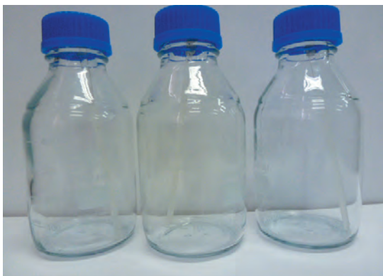
Rys. 3.32. Butelki do badania odmycia lepiszcza z kruszywa metodą A na aparacie do rolowania wg PN-EN 12697-11 (fot. ORLEN Asfalt sp. z o.o.)
